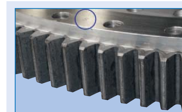
Kennzeichnung des Härteschlupfes Marking of soft-zone
