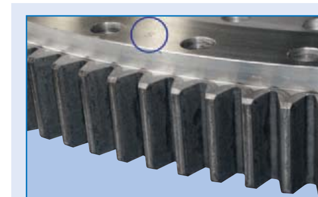
Kennzeichnung des Härteschlupfes Marking of soft-zone
